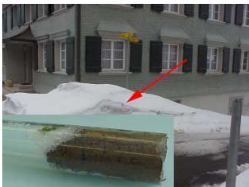
Entnahmeort des Bohrkerns B (Pfeil) mit unterem Teil des Kerns
